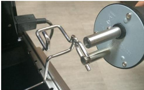
4. Faire un mouvement de rotation du moteur vers l'avant pour poser l'axe tournant du moteur sur le portique
